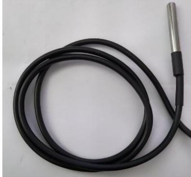
**Fig 3.** Temperature sensor DS18B20.
