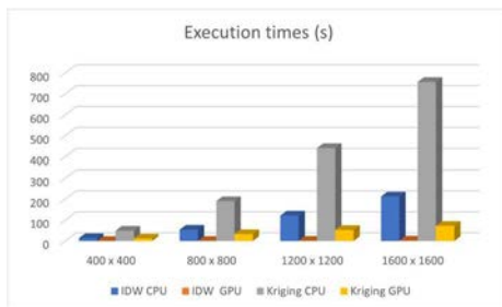
Figura 5.9 Timpii de execuție pentru IDW și Kriging pe CPU și GPU
