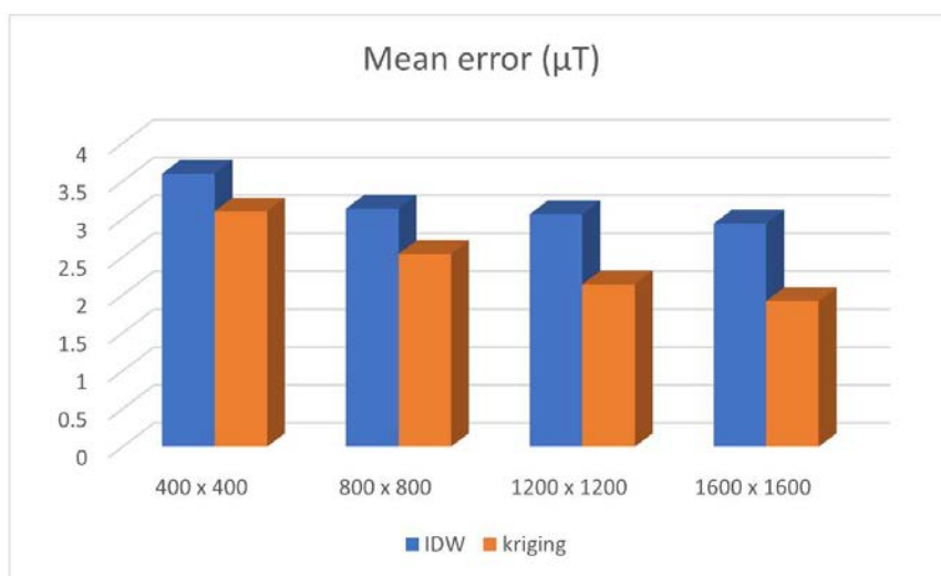
Figura 5.8 Comparație între eroarea medie pentru câmpul geomagnetic obținut prin IDW și Kriging
