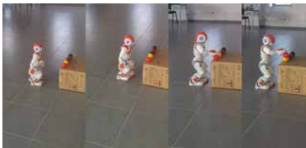
Fig. 6.14. Operatorul este așezat în fața senzorului Kinect. El indică prin gest (pointing) una dintre cele trei cutii și îi cere robotului să îi aducă un obiect colorat situat pe aceea
