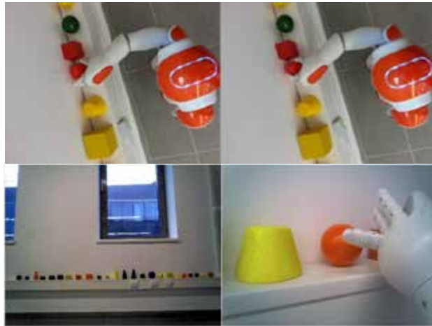
Fig. 6.7. a), b) NAO apucând mingea cu o singură mână; c), d) Câmpul vizual al robotului
