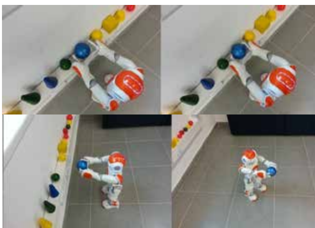
Fig. 6.9. Robotul NAO apucând o minge cu ambele mâini
