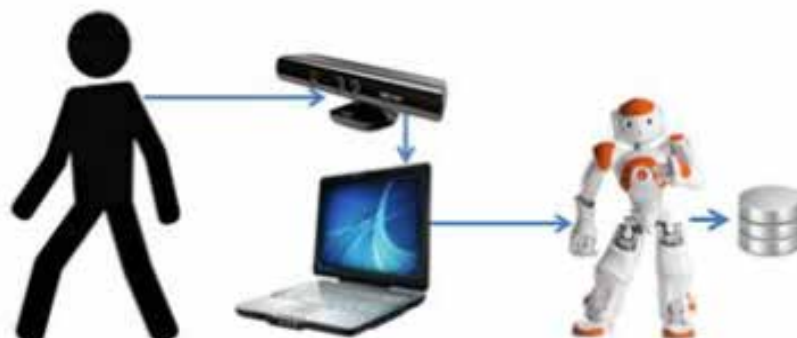
Fig. 4.16. Schema generală a sistemului de teleoperare bazată pe gesturi
