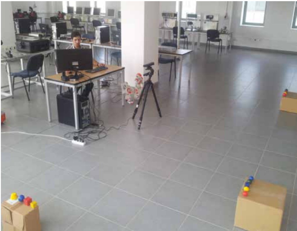
Fig. 6.14. Operatorul este așezat în fața senzorului Kinect. El indică prin gest (pointing) una dintre cele trei cutii și îi cere robotului să îi aducă un obiect colorat situat pe aceea
