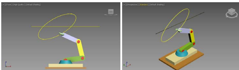
Fig. 5.41. Modificarea traiectoriei efectorului
