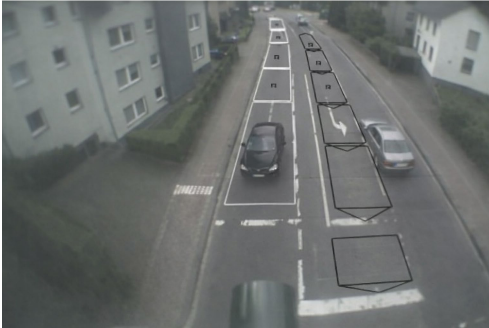
Figura 2.17. Program de urmărirea a traficului observat de camera video fixă
