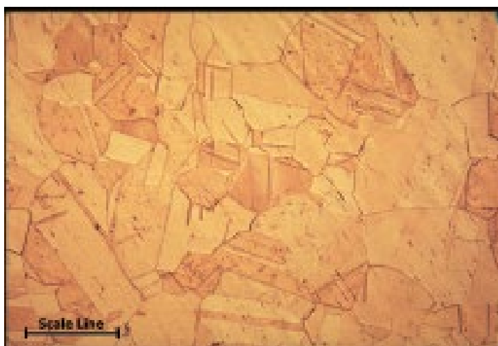
Fig. 1.29. Alamă cu un conținut mai mic de 39%Zn – CuZn30 [2]
